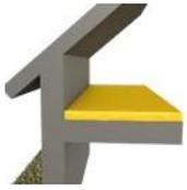
**Ajout d'une isolation sur le plancher des combles perdus : 280 mm de ouate de cellulose soufflée - R = 7.1 m<sup>2</sup>.K/W - Surface isolée = 90 m<sup>2</sup>**
